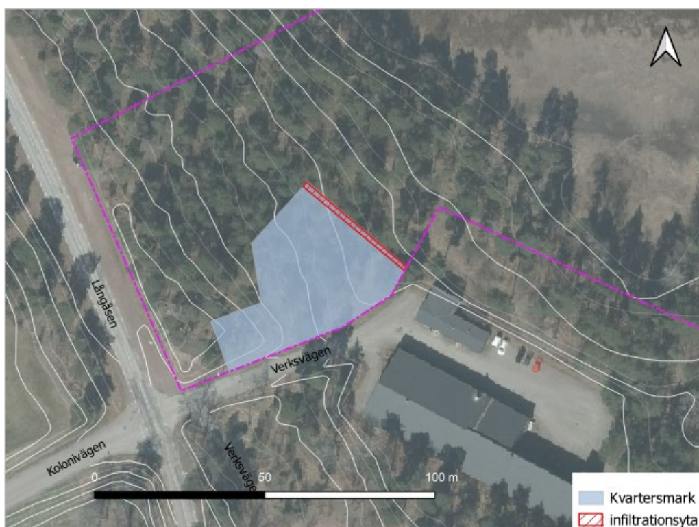
Figur 5. Föreslagen dagvattenhantering med infiltrationsyta
